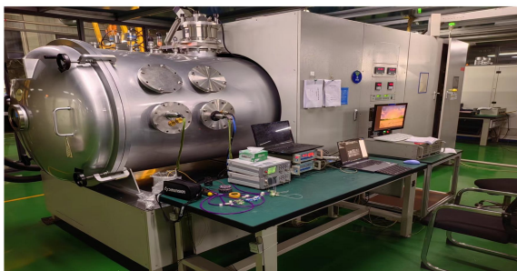
(b) 寿命试验使用的热真空罐
