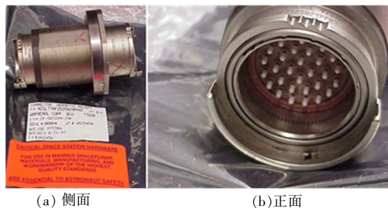
图 6 Amphenol 公司为 ISS 生产的气密穿舱光纤连接器
