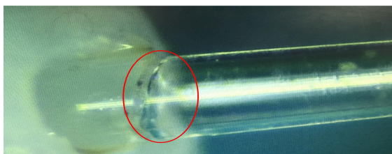
(d) 36 h 后裂纹生长
