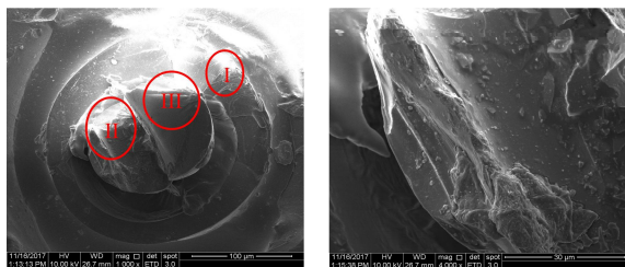
图 6 A 组光纤断裂截面的 SEM 图及断裂区域放大图
