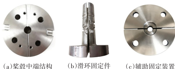
图3 光纤布线防护关键部件实物图
