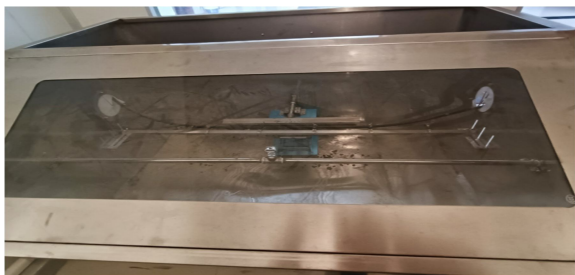
(b) 耐水火喷淋试验
