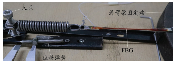
图 3 实验平台搭建示意图
