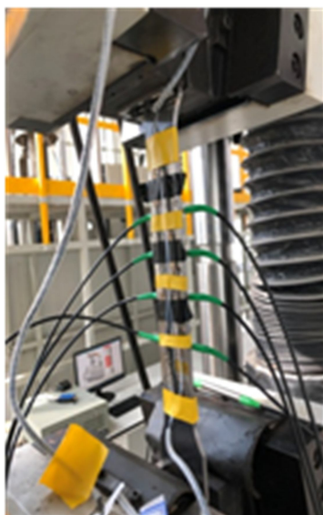
(b) 试件夹持在试验机的实物图
