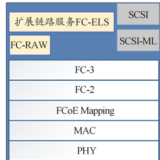
图 5 高速接口模块协议层次结构图
