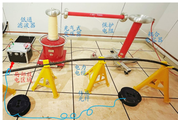
图5 高压系统搭建平台
