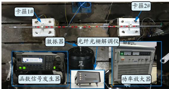
图3 液压管路实验台实物图
