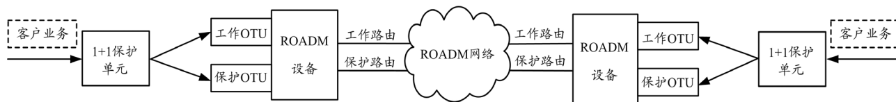
图 1 光通道层线性 1+1 保护
