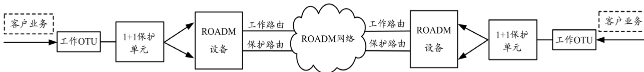
图 2 光复用段线性 1+1 保护
