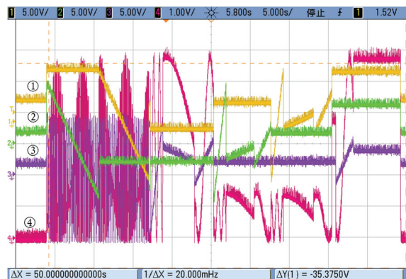
①调节Q分支MZM偏置电压; ②调节I分支MZM偏置电压; ③调节马赫-曾德干涉仪偏置电压; ④得到DP-MZM输出光功率
