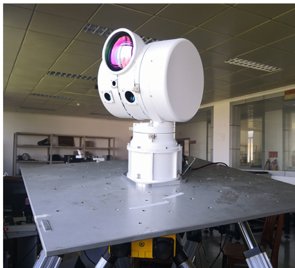
图 8 六轴摇摆台搭载条件下测试试验现场照片
