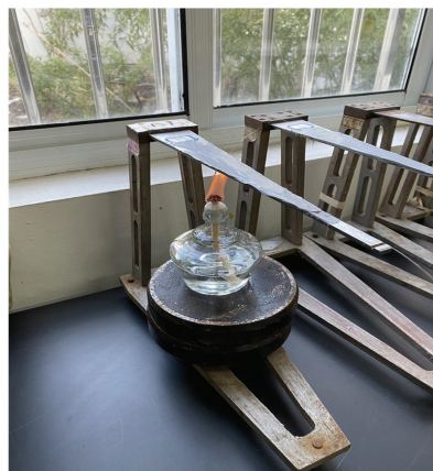
图 3 酒精灯灼烧等强度梁实物图
