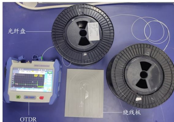
图1 不同弯曲半径下单模光纤宏弯损耗测试装置
