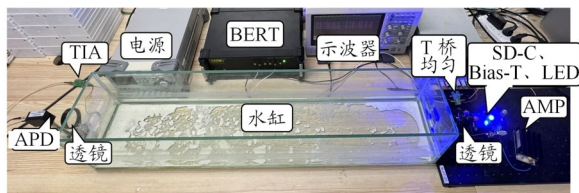
图6 UWOC系统实验装置图
