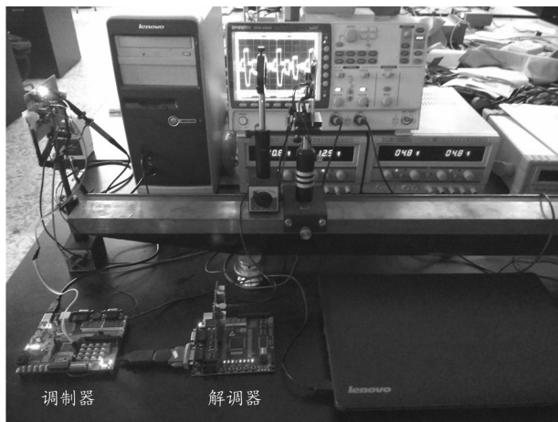
图5 VLC通信系统实验设备
